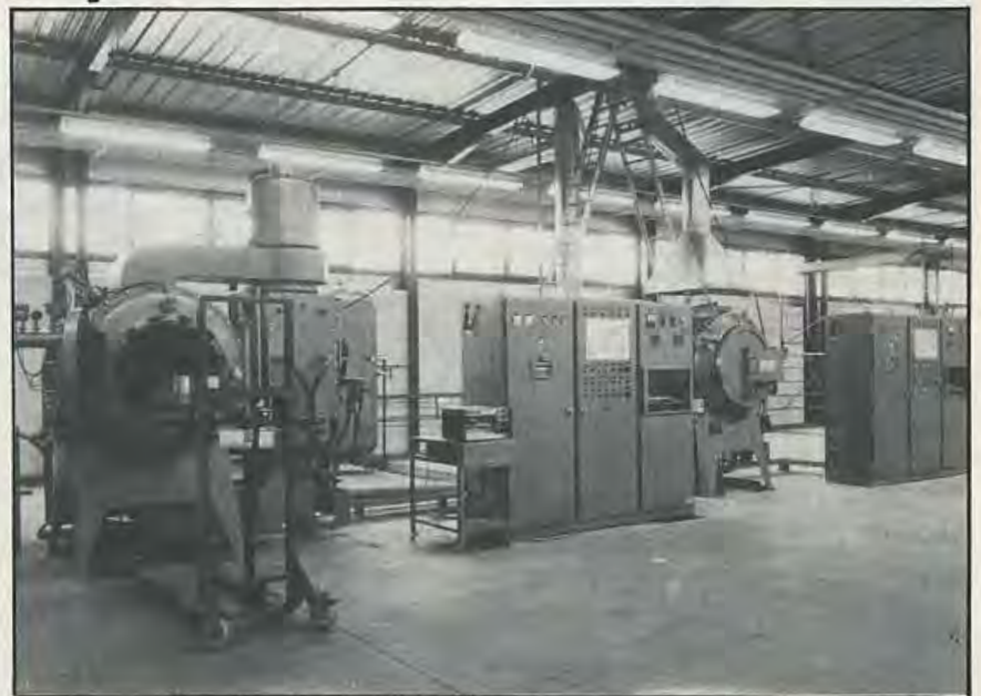
Chaîne de traitements thermique sous vide nouvellement implantée à MP. A gauche, ouvert le four de trempage. A droite, le four de recuit.
